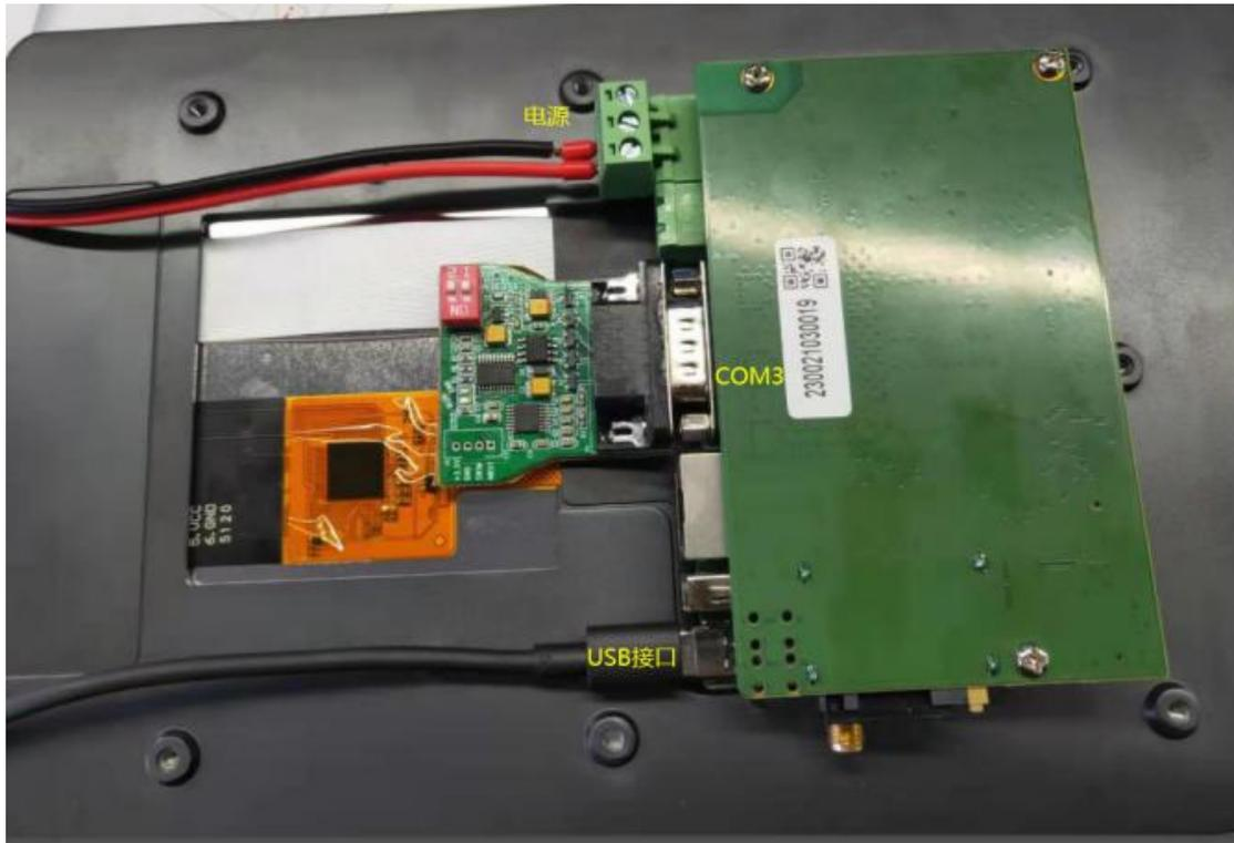
4. 以上步骤操作后，屏仍然正常进入组态画面的话，请断开 HMI 电源，拆除 HMI 后盖，
