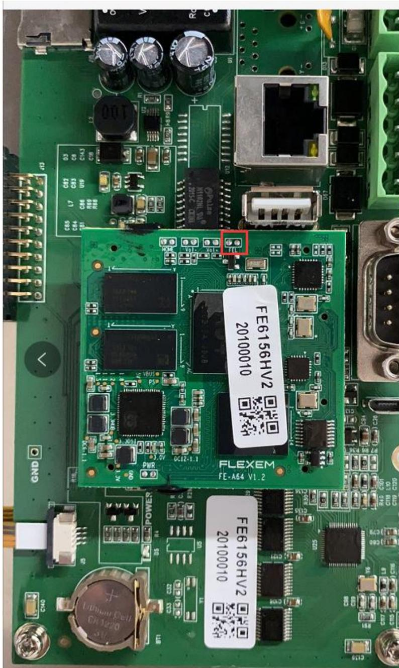
短接图中两个焊点（请不要短接其他任何元件以防硬件损坏），在短接焊点的情况下，给 HMI 通电，正常情况下，HMI 应该进入白屏状态
