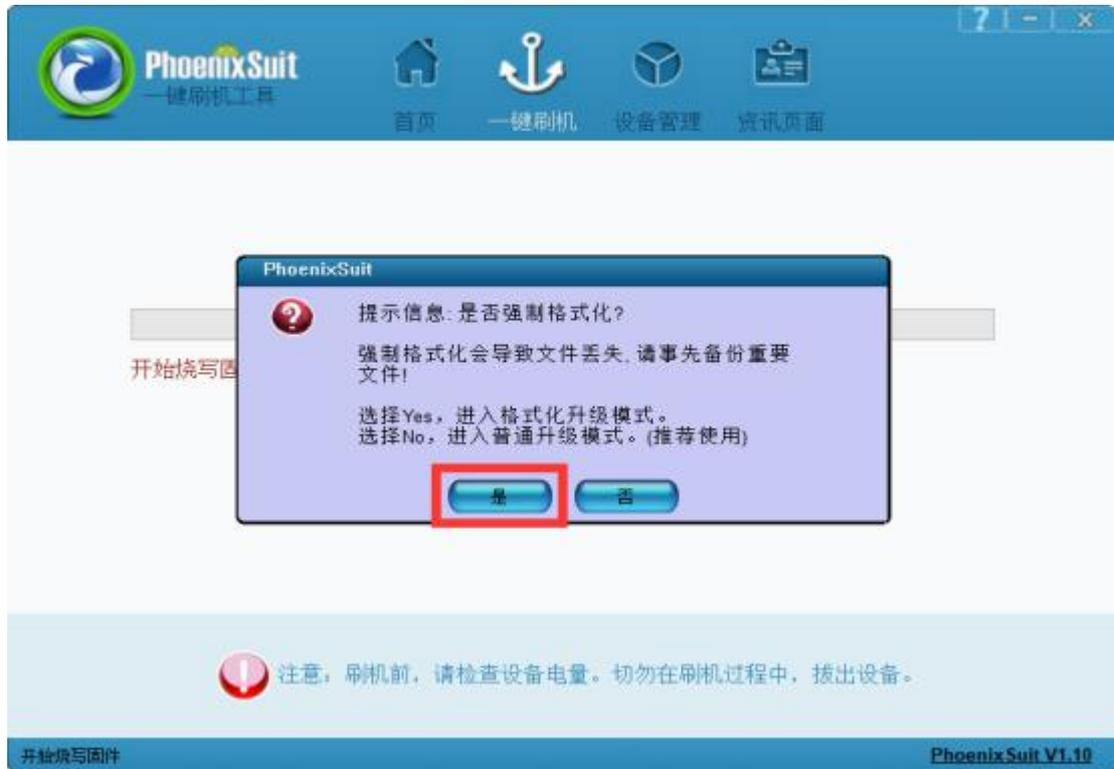
6.点击“是”，等待大概 30s 后，提示“固件烧录成功”，不要点确认，直接关闭 HMI 电源后，再点确认，随后断开 BOOTME 工具
