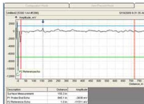
图 3. 如果表面信号较弱，则导波杆末端探测功能使用导波杆长度和介电材料确定产品表面。
