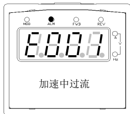
图 4-4 故障告警显示状态
