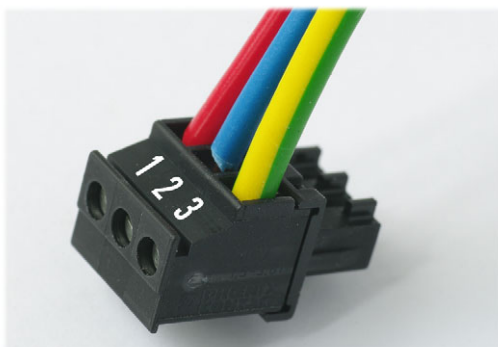
图 4-5 接线端子的针脚分配
