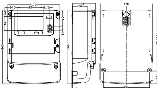
图 1: 安装尺寸图
