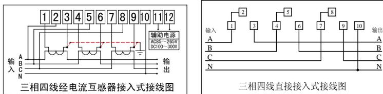
注：辅助电源为可选功能，具体接线以表计端盖上接线图为准。
