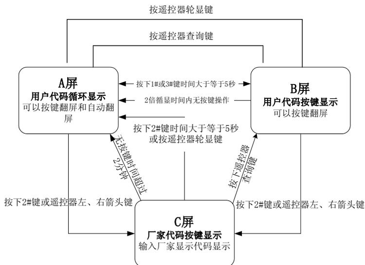
电表平时自动轮显 A 套显示项内容；若持续按住 1#或 3#键大于 5 秒则进入 B 套显示方式；在 B 套显示方式下若持续按住 1#或 3#键大于 5 秒则返回 A 套显示方式。
