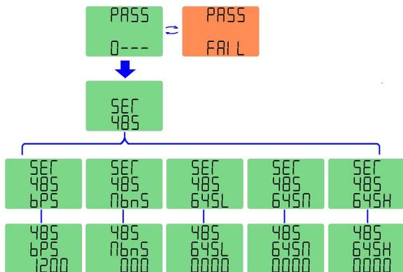
任意时刻下，同时按下仪表的“←”和“→”键进入“PASS”屏，显示数据第一位表示密级，后三位为密码（按“▲”，切换输入位），按“▼”，切换输入位），按“←”键确认。若密级和密码输入不正确，则出现错误提示“FAIL”。这时按“←”
