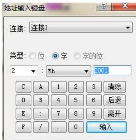
点击“写入地址”后面的小键盘会出现上图的界面，根据实际的变频器的连接端口选择连接号，本例是连接 1；并根据实际的变频器站地址选择变频器的站号，本例中变频器的站号是 2；然后选择读写的类型，对于 HMI 与变频器的通信需要选择 Wh（Wh 就是以十六进制格式填写后面的地址，访问类型是字），原因是 GD300 的 modbus 地址是以十六进制给出的；最后填写具体的访问地址，本例填的是 2001，对应的变频器功能是通过通信设置变频器频率。
